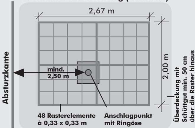
Schematische Darstellung der Standardverlegung des mittig platzierten Anschlagpunktes mit den vier vorgesteckten Rastergruppen ( $1,00 \times 1,33$  m).
