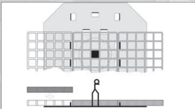
3. Die Raster müssen vollständig auf der Grundplatte aufliegen und die senkrechten Laschen die Nachbarelemente hintergreifen.
