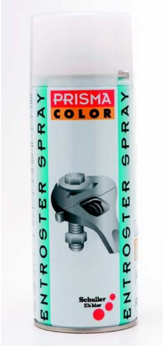
**Beschreibung:** Extra starke Zusammensetzung mit 4 Funktionen: löst Rost, trocknet, schmiert und schützt das Metall. Verhindert die Entstehung von Dampf auf elektrischen Kontaktflächen. Schmiert metallische Oberflächen und hinterlässt einen wasserabweisenden Film. Schützt vor Oxidation und Korrosion. Enthält spezielle Rostlöser. Einsatz: Löst in kurzer Zeit korrodierte Schrauben, Bolzen, Federn, Schlösser, Scharniere, Beschläge, usw. Automatische Ventilreinigung durch ein spezielles Ventil.
