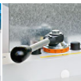
Werkzeugfrei justierbare Schnittspalteinstellung
