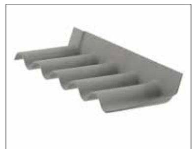
Maueranschlussstück Maueranschlussstück 150mm/300mm 110°, Welle W177 5.5 oder 6.5 rechts (Deckrichtung von rechts nach links)
