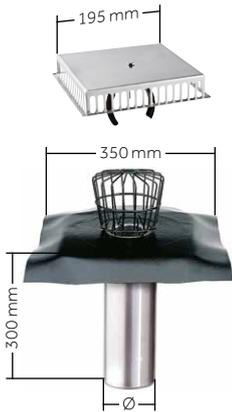
Erhältlich mit einem Wolfen oder einem universellen, grauen Bahnenflansch. Systemteile können in Titangrau oder mit original grauem Wolfen Bahnenflansch als Sonderanfertigung bestellt werden. Materialstärke 0,7 mm, Rohrlänge 300 mm für Dämmstoffdicken von 115 bis 230 mm, passend für Grundelement oder Rohr mit Muffe. Kombinierbar mit Kiesfang SD für höhere Ablaufleistungen.
