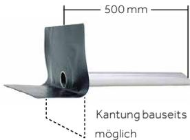
Der Wasserspeier ist besonders gut geeignet für die Entwässerung von Balkonen und Kleinflächen. Materialstärke 0,7 mm, Rohrlänge 500 mm, Edelstahl-Verbundblechflansch und Bahnenflansch. Erhältlich mit einem Wolfen oder einem universellen, grauen Bahnenflansch. Systemteile können in Titangrau oder mit original grauem Wolfen Bahnenflansch als Sonderanfertigung bestellt werden.
