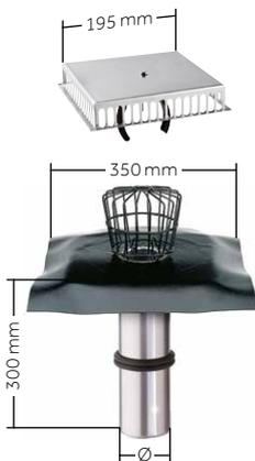
Erhältlich mit Wolfen Bahnenflansch, Materialstärke 0,7 mm, Rohrlänge 300 mm, Eintauchtiefe in vorhandenens Gullysystem/Rohr mind. 70 mm, passend für ein Rohr ohne Muffe. Kombinierbar mit Kiesfang SD für höhere Ablaufleistungen.
