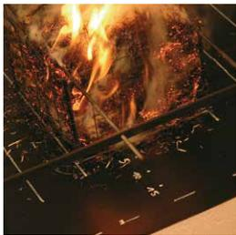
Durch die spezielle Bahnenrezeptur mit dem intergriertem Glasvlies wird das Durchbrennen der Flammen bei Feuerbeaufschlagung zum Dämmstoff erfolgreich verhindert.
