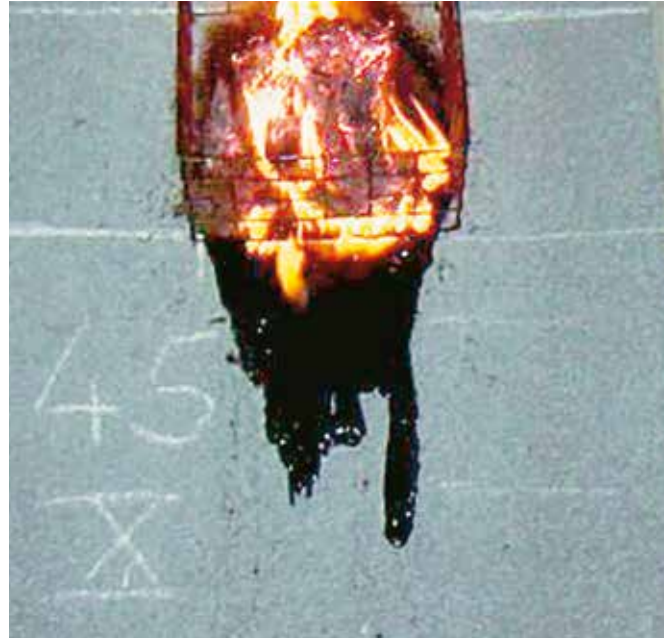
Das Ergebnis ist abhängig von dem Zeitpunkt des Erlöschens der Flamme, den Ablauflängen brennender Teile, dem Entstehen von Löchern, Flammen oder glimmenden Stellen an der Dachunterseite sowie den sichtbar glimmenden Stellen im Dachaufbau.
