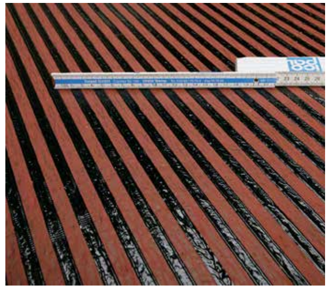
Dynamische Abzugfestigkeit 6.600 N/m 2 (durch Prüfzeugnis nachgewiesen)
