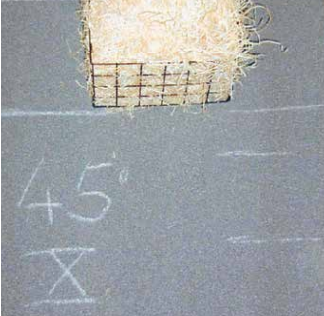
Bei der Brandprüfung nach DIN 4102-7 bzw. DIN CEN/TS 1187 wird eine definierte Brandlast an genau vorgeschriebenen Stellen auf der zu testenden Abdichtung entzündet.
