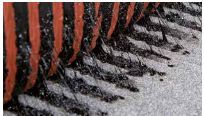
Power-Therm-Streifen mit roter Syntan-Beschichtung
