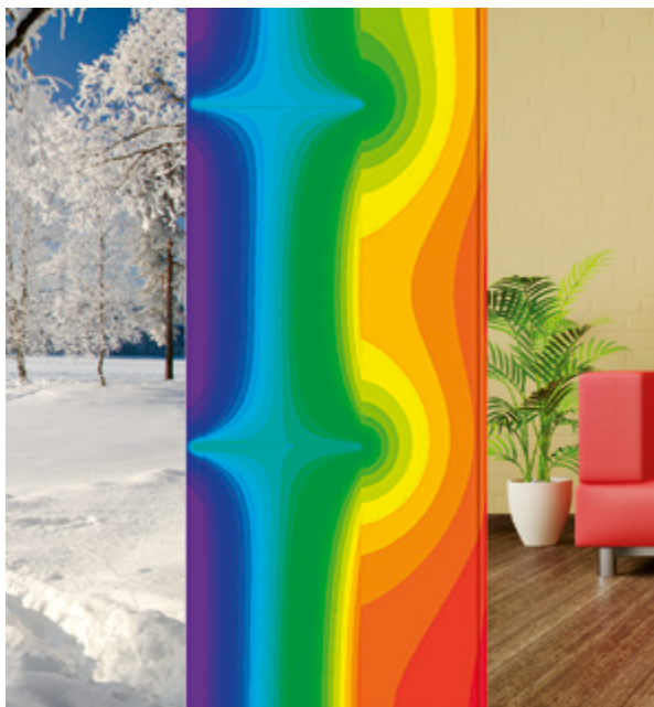
Abbildung 1 Ausgeprägte Wärmebrücke bei Aluminiumkonsolen
