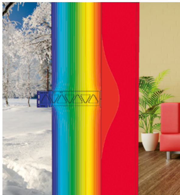
Abbildung 2 Minimale Wärmebrücke bei CROSSFIX®
