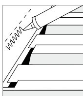
2. Auftragen der Dichtungsmasse unterhalb der Dichtungslinie.
