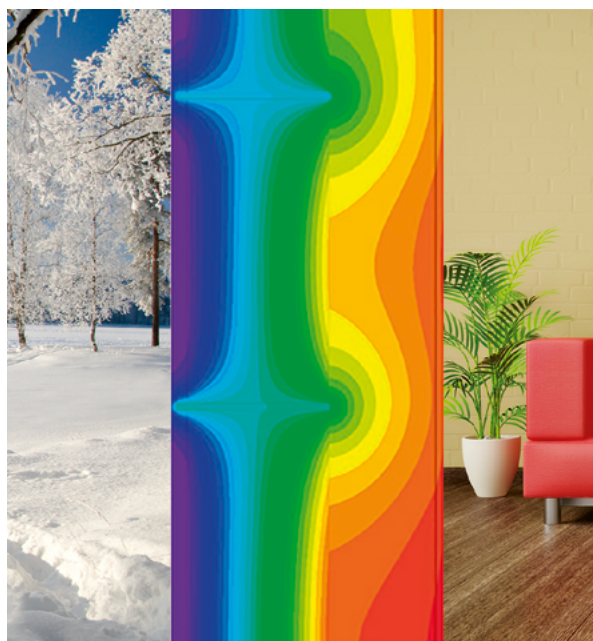
Abbildung 1 Ausgeprägte Wärmebrücke bei Aluminiumkonsolen
