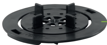
TERRASYS Schienengleiter Flex Flexibel in x- und y-Achse sowie um die eigene Achse beweglich. Hierdurch lassen sich Toleranzen des Bodenbelags und Ungenauigkeiten beim Verlegen der Unterkonstruktion ausgleichen.
