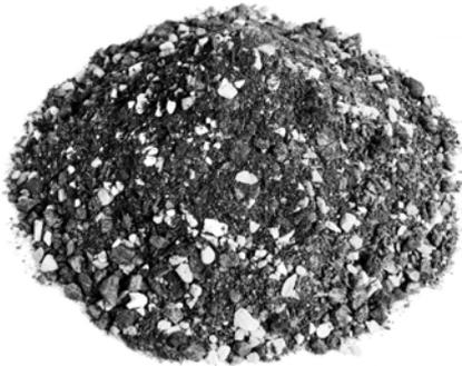
Mit Leichtzuschlagstoffen angereichertes blasbares Vegetationssubstrat für Intensivbegrünungen in mehrschichtiger Bauweise.
