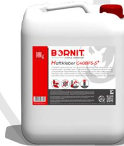
Kationenaktive, mit ca. 40% Bindemittelgehalt hergestellte Bitumenemulsion. Qualität nach TL BE-StB 15. Zum Vorspritzen verschmutzter und gealterter Asphaltflächen; als Vorbehandlung für das Aufbringen von Mischgut oder kationenaktiver Bitumenemulsion. Haftvermittler im Schichtenverbund zwischen Asphalt-schichten der Bauklassen BK 0,3 bis 1,8.
