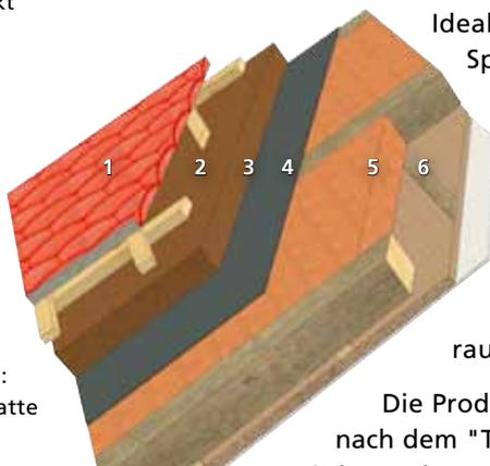
Idealerweise wird zuerst der Bereich zwischen den Sparren gedämmt – z.B. mit dem flexiblen Holz-faser-Dämmstoff STEICOflex aus dem STEICO System. Häufig sind Altbau sparren aber zu gering dimensioniert, um allein mit einer Zwischensparrendämmung zeitgemäße Dämmwerte zu erreichen. Mit STEICOspecial dry ist es möglich, die erforderliche Zusatzdämmung oberhalb der Sparren anzubringen. Der Wohnraum unter dem Dach wird nicht beeinträchtigt.
