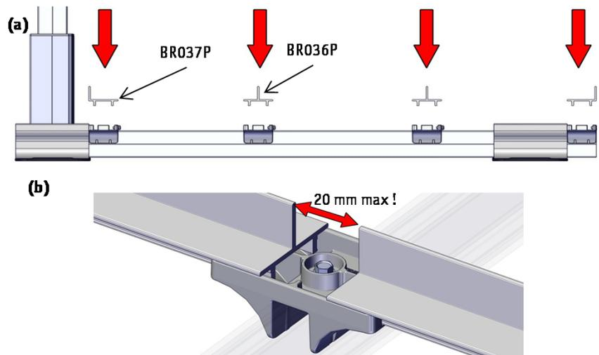
Seitliches fixieren der L- und T-Profile auf den Schienenkrallen mit jeweils zwei Innensechskant-Linsenkopfschrauben (TX0066, M6x12, Inbus Nr. 4, Drehmoment 7 Nm).
