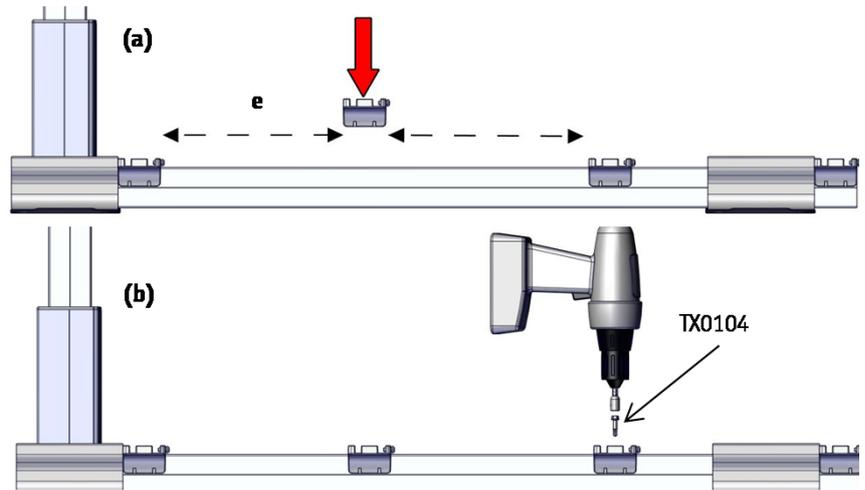
Die L-Profile BR037P auf die beiden außenliegenden Schienenkrallen und die T-Profile BR036P auf die innenliegende(n) Schienenkrallen auflegen **(a)**.
