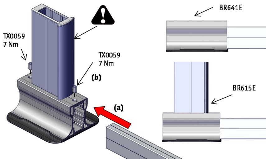
Zwischen zwei Auslegerschienen mit "Multi-Verbinder und Stützhülse (BR615E)" muss zur Lastverteilung eine Auslegerschiene mit "Multi-Verbinder ohne Stützhülse (BR641E)" verlegt werden.
