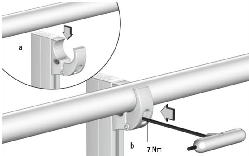
Mit der seitlich zugänglichen Schraube M5 x 18 (TX0036) ist eine nachträgliche Höhenjustierung der Geländerprofile jederzeit möglich.
