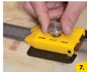
7. Schnittmaß am Gerät einstellen. Dazu Rändelschraube lösen und den Schlitten auf dem Lineal verstellen und fixieren.
