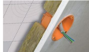
Für Elektroverteilungen und -dosen ist eine Installations-ebene notwendig. Diese sollte mit Dämmstoff gefüllt werden.
