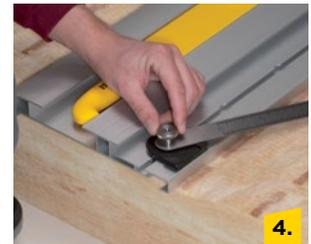
4. Rändelmuttern lösen und Lineale ausklappen.
