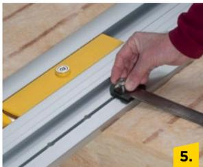
5. Dämmstoffbreite einstellen. Dazu Rändelmutter öffnen. Dann die Kunststoffplatte leicht anheben und verschieben.
