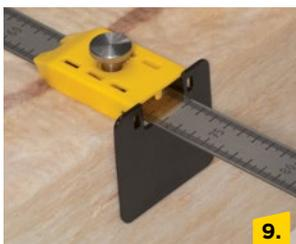
9. Integra FastCut auf dem Filz ausrichten. Dann die Schneideunterlage passend unter dem Dämmstoff positionieren.
