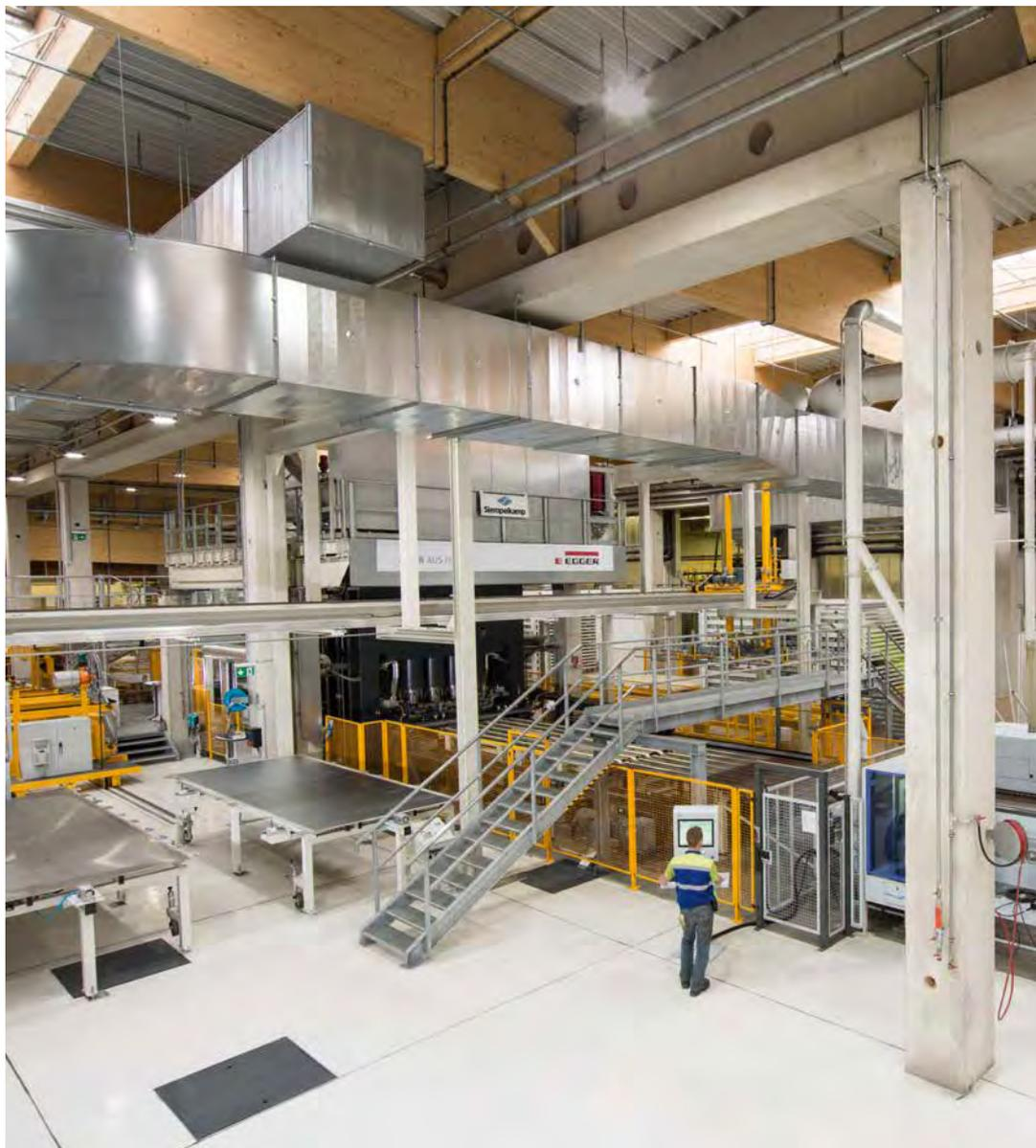
High-Tech im Einsatz: Die 2013 in Betrieb genommene Kurztafelanlage in St. Johann in Tirol (AT) ist die erste ihrer Art und wird für die Beschichtung von Platten mit tiefen Oberflächenstrukturen, beidseitigen Synchronporen-Oberflächen sowie für die Verpressung und Beschichtung von Kompaktplatten und Dünnpfatten eingesetzt.
