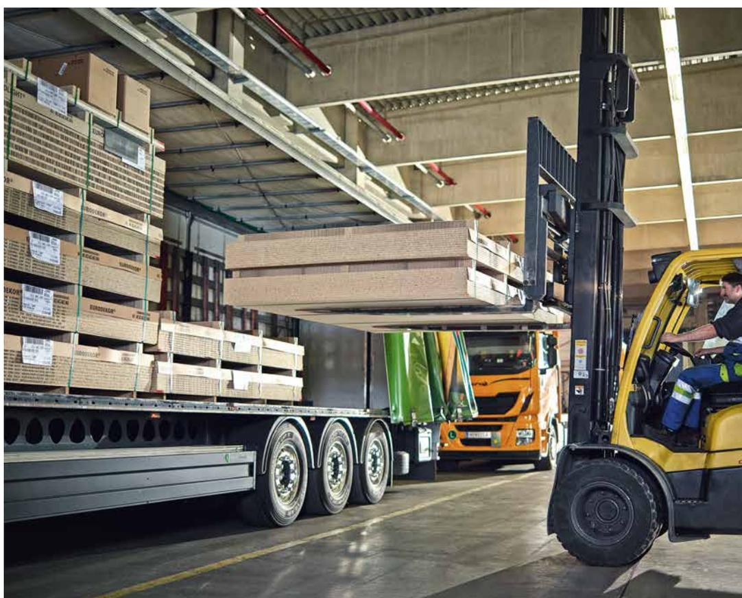
Logistik mit Leichtigkeit und Innovationsgeist: für den Transport von Plattenpaketen verwenden wir eigens angefertigte Unterleger aus Eurolight Leichtbauplatten. So sparen wir pro LKW 294 kg Gewicht ein und können umso mehr Ware laden – allein am Standort Brilon (DE) sind das 16.154 kg pro Tag.
