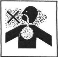
Arbeiten Sie mit dem Gerät nur im Freien oder in gut durchlüfteten Räumen. Das Gerät verursacht Abgase und somit Kohlenmonoxid CO. Einatmen von CO ist gesundheitsschädlich.
