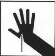
Benutzen Sie das Gerät nur für den dafür vorgeschriebenen Zweck. Bei betriebsbarem Gerät Hände weg im Bereich Nasenstück. Gerät immer so halten daß es mit dem Nasenstück nicht auf eigene Körperteile zeigt.
