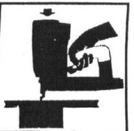
Vor jedem Arbeiten mit dem Gerät, überprüfen was sich hinter der Arbeitsfläche befindet. Es muß sichergestellt sein, daß der Eintreibgegenstand keine Kabel, Gas-, Heiz-, oder Wasserleitungen treffen kann. Eintreibgegenstände sind nur für die Befestigung von Holz auf Holz oder Werkstoffen mit gleicher oder niedrigerer Festigkeit zu verwenden, wenn nicht anderweitig spezifiziert.
