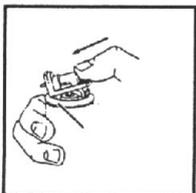
Dosierventil mit vorderer Einrastrille in die Kerbe der Fuel Cell setzen.
