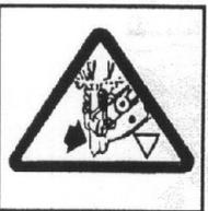
Eintreibgeräte die mit einem auf der Spitze stehenden, gleichseitigen Dreieck gekennzeichnet sind dürfen nur mit Auslösesicherung verwendet werden.
