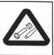
Von Zeit zu Zeit alle Schrauben, Muttern und Teile auf festen Sitz prüfen. Nie mit einem Gerät arbeiten das Störungen aufweist. Wir empfehlen in geeigneten Zeitabständen eine Überprüfung in einer Paslode Service Werkstatt.
